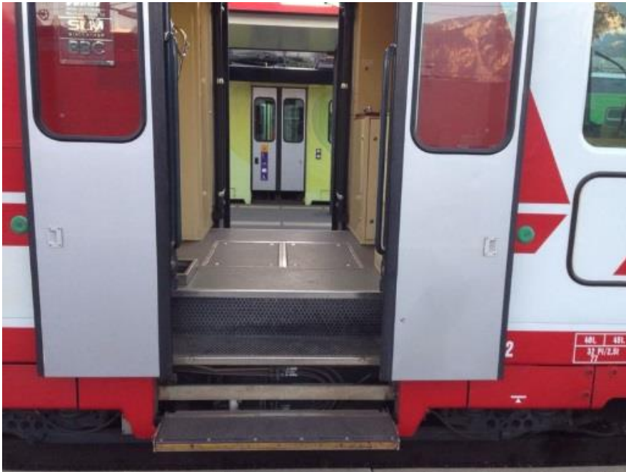
Marches trop hautes pour accéder au train
